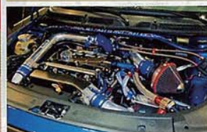
↑オーストリアのGT-POWER製ターボキットや同ECUを組み込んだ心臓部。この製作プロジェクトの様子は同店ブログで公開中!
