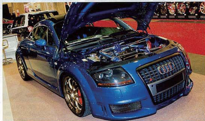
↑オーストリアのGT-POWER製ターボキットや同ECUを組み込んだ心臓部。この製作プロジェクトの様子は同店ブログで公開中!
