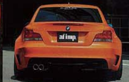
↑リアフェンダーは片側7cmワイド。リアバンパースポイラーはE87用リアル製品が土台だが、その作業はほぼワンオフとのこと
